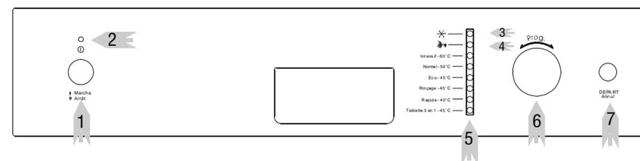
1. Bouton MARCHE/ARRET : pour activer/désactiver l'alimentation électrique. Veuillez noter que ce modèle possède une fonction 'mémoire' : si une coupure d'électricité se produit, la machine ne réinitialise pas le programme en cours. De ce fait, vous ne pouvez pas annuler un programme en éteignant l'appareil.
