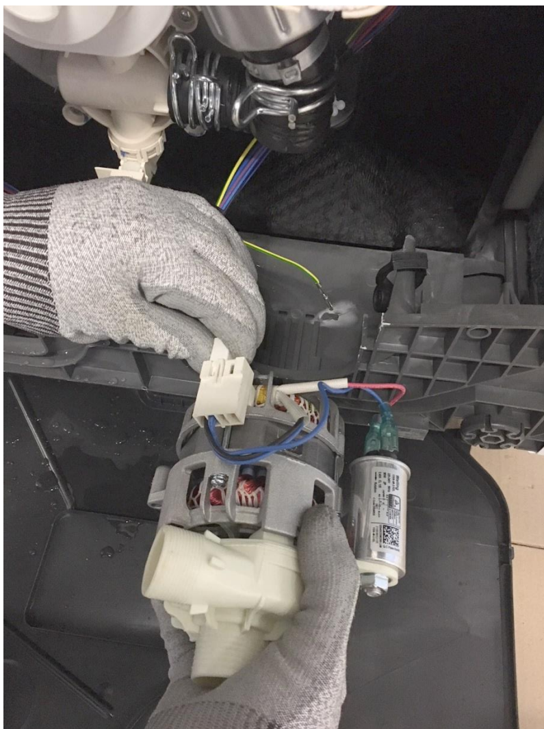
13 – Débrancher le connecteur
