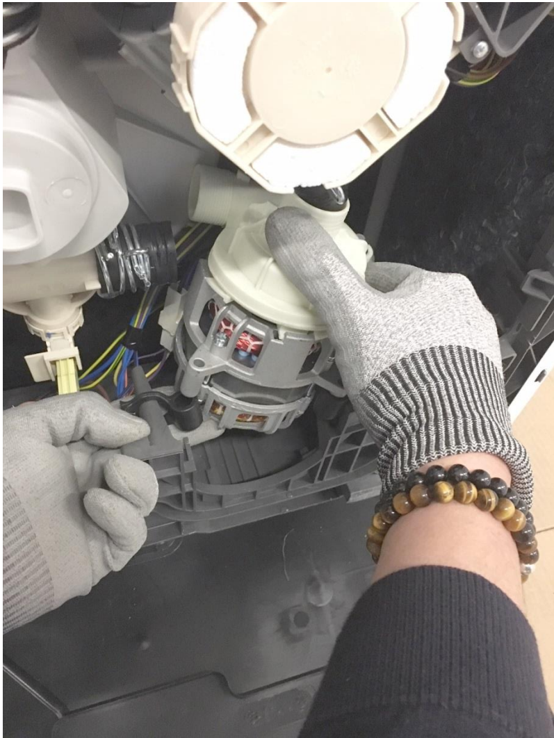
17 – Remonter le nouveau moteur cyclage
