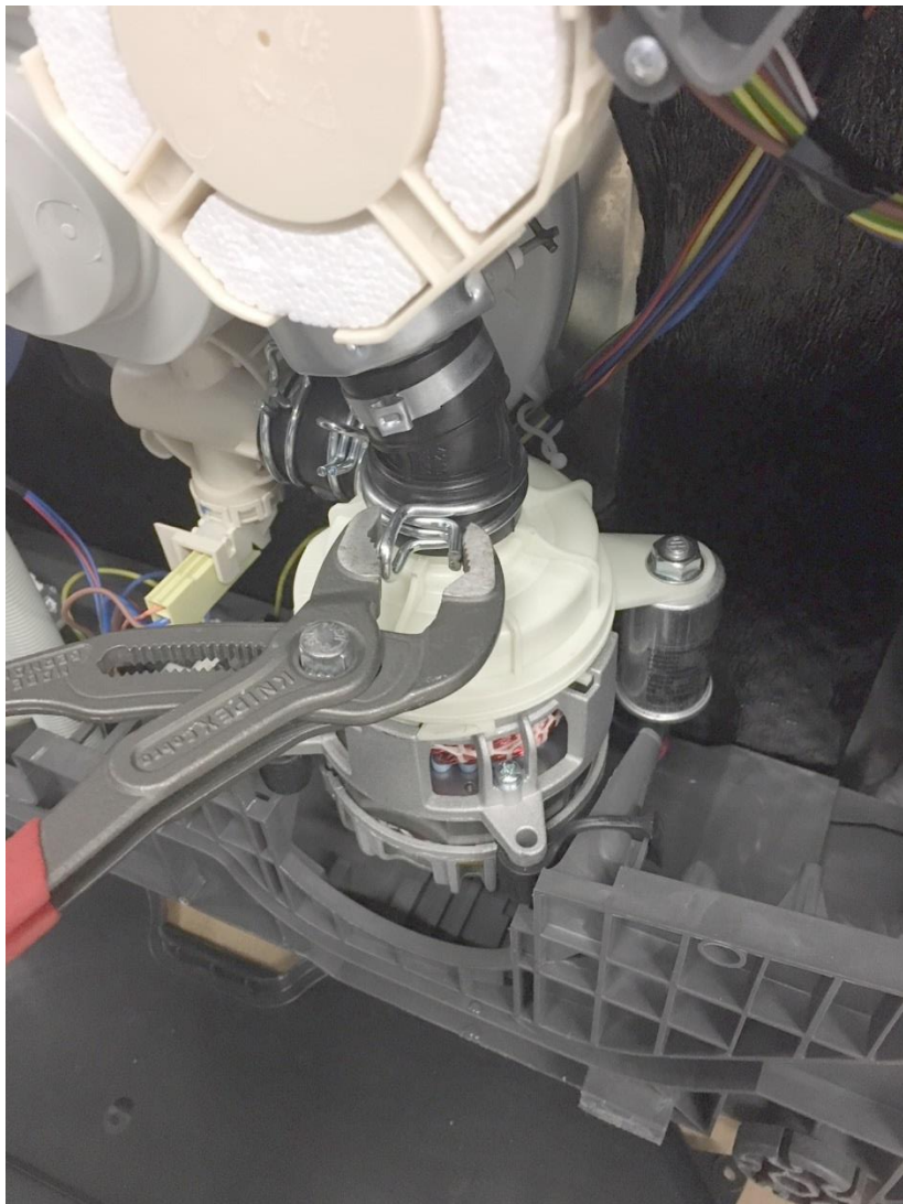
22 – Repositionner le collier moteur-résistance
