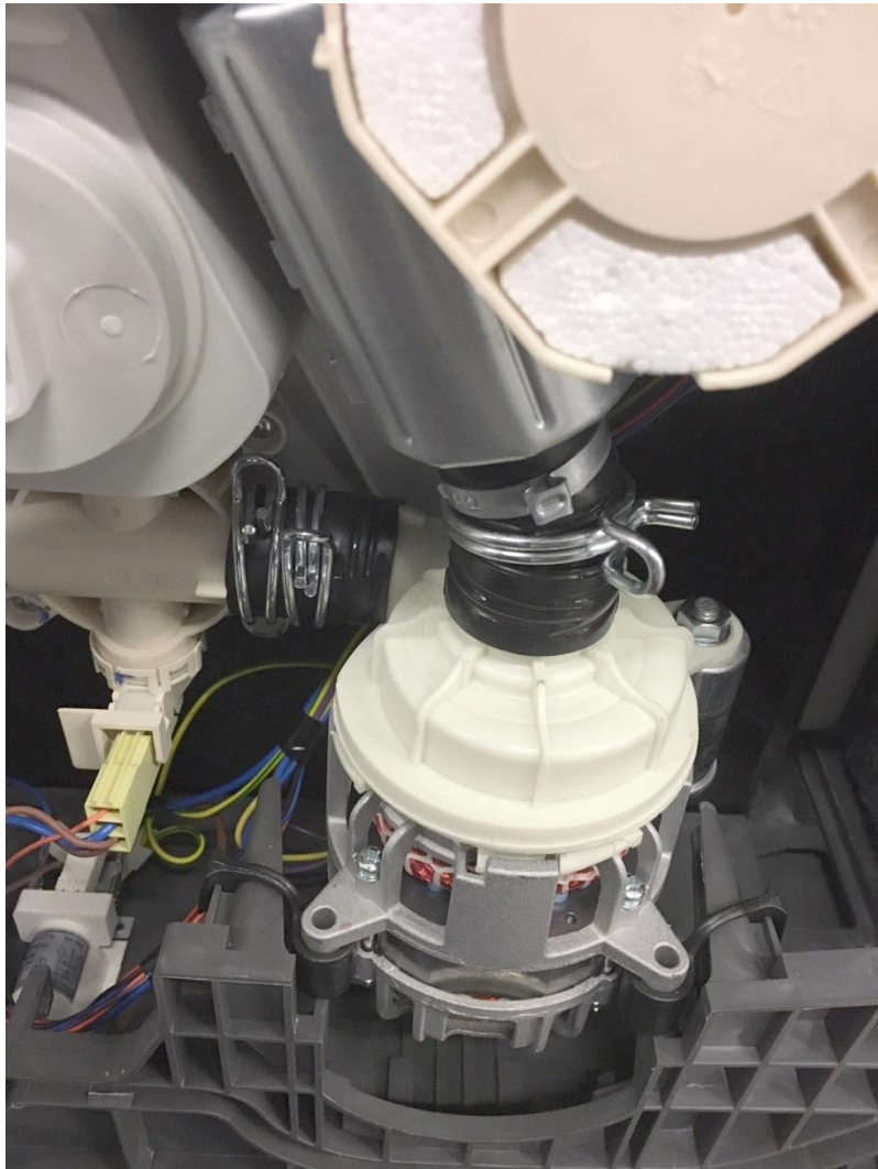
20 – Photo des durites remontées
