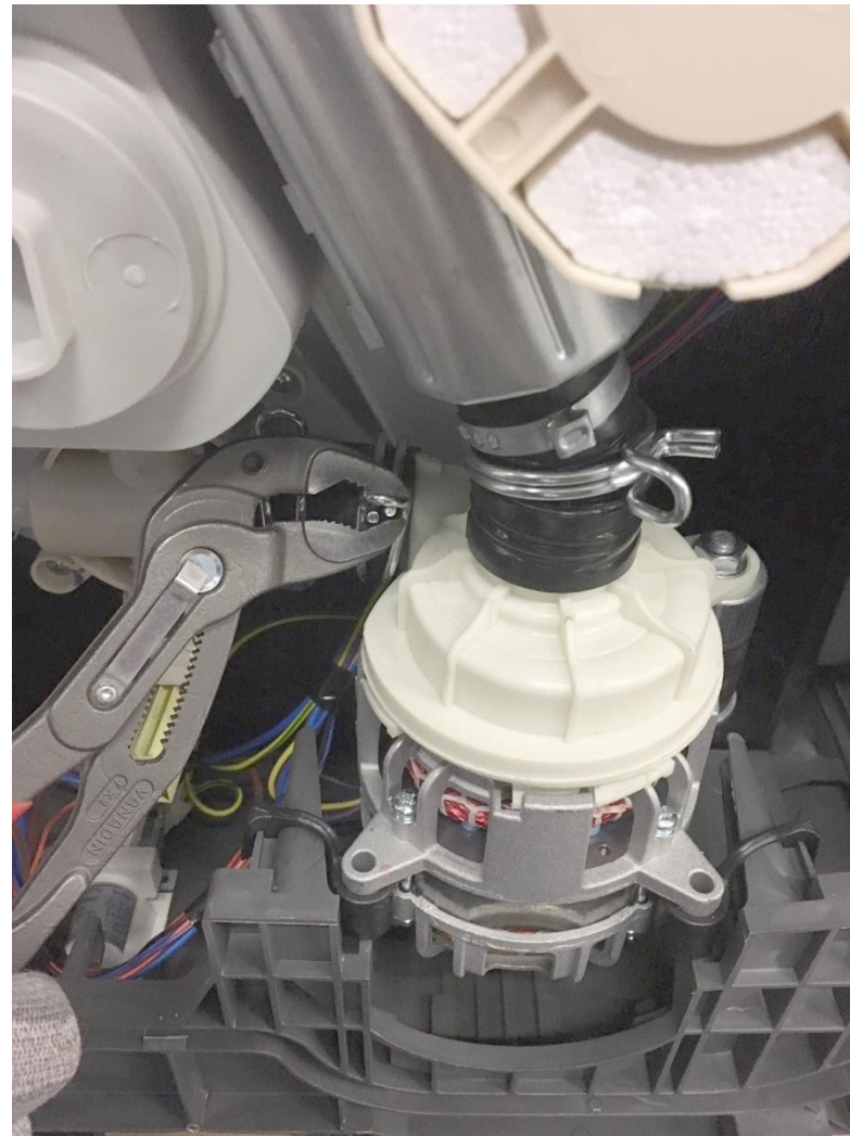
08 – Retirer le collier moteur-répartiteur
