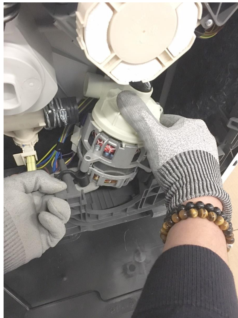
12 – Désolidariser le moteur des silentbloc gauche et droite
