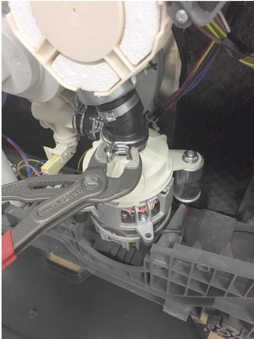
06 – Retirer le collier moteur-résistance
